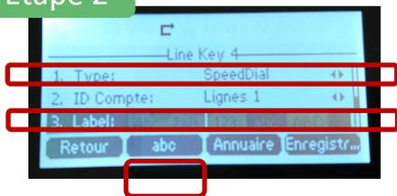
Sélectionnez le type “Speed Dial” au moyen de la molette de contrôle
